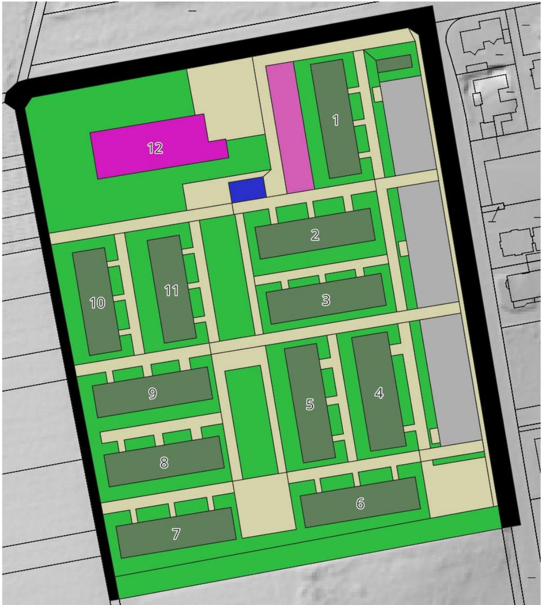
Abbildung 8: Dachflächen für eine mögliche Regenwassernutzung
