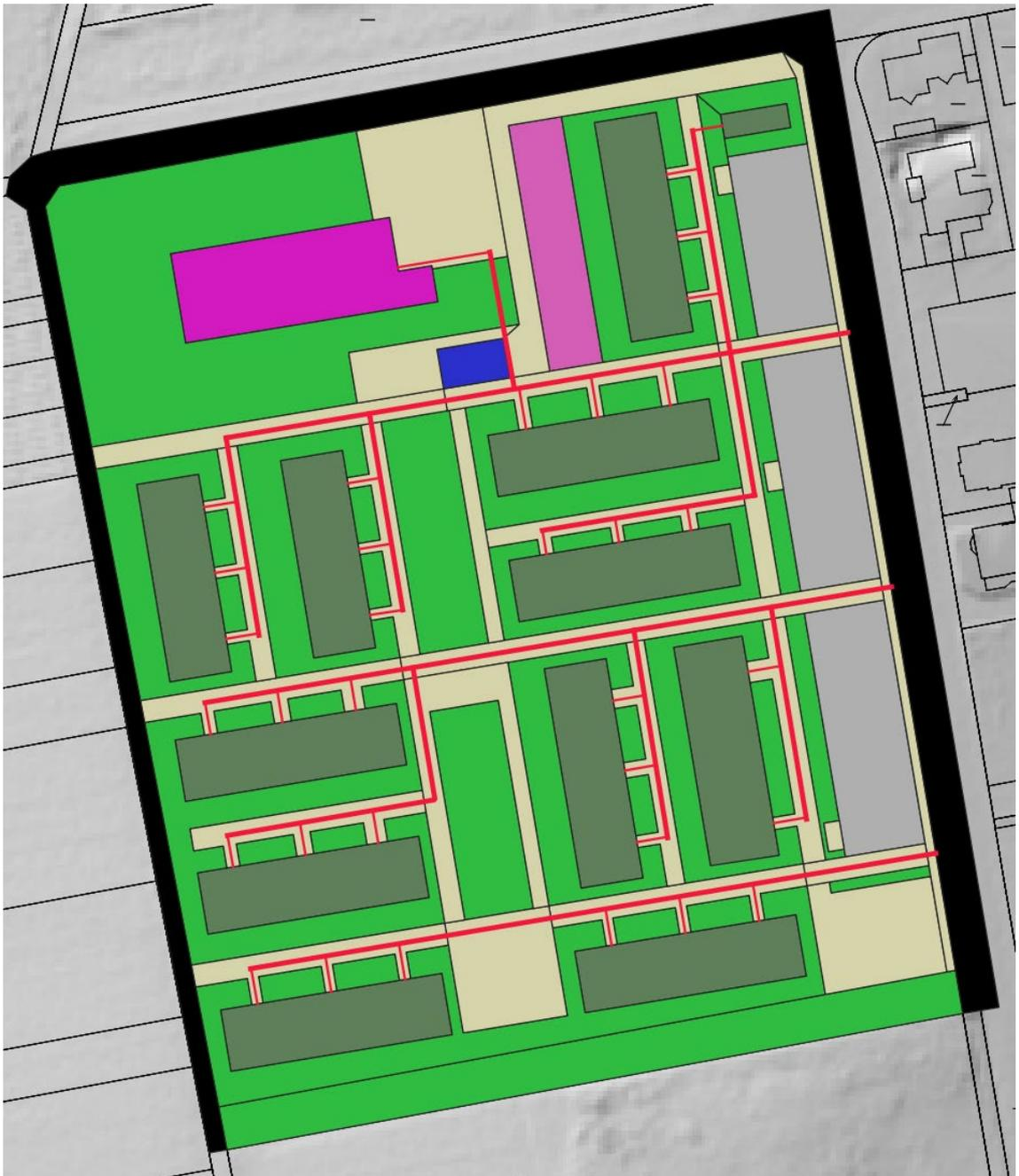
**Abbildung 13:** Vorschlag zur Verlegung der Schmutzwasserleitungen
