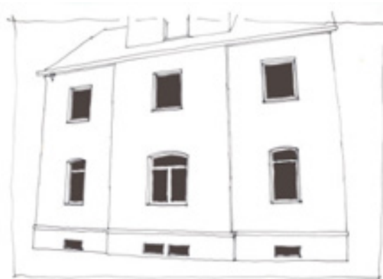
Ansicht ohne Fenstereinfassungen. Durch die relativ kleinen Fensteröffnungen wirkt die Fassade sehr geschlossen.
