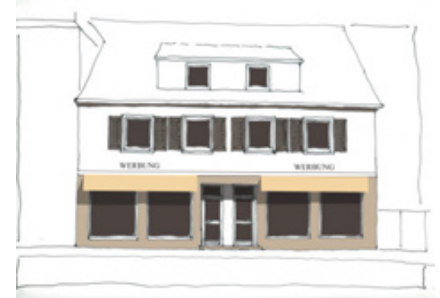
Markisen lassen sich kleinteilig in die Fassade integrieren, ohne den Gesamtzusammenhang zu zerstören.
