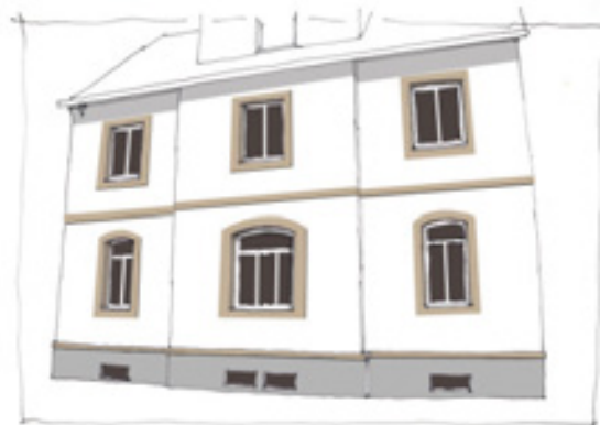
Ansicht mit Fenstereinfassungen und schmalem Gesims. Die Öffnungen wirken großzügiger, die Fassade erscheint offener.
