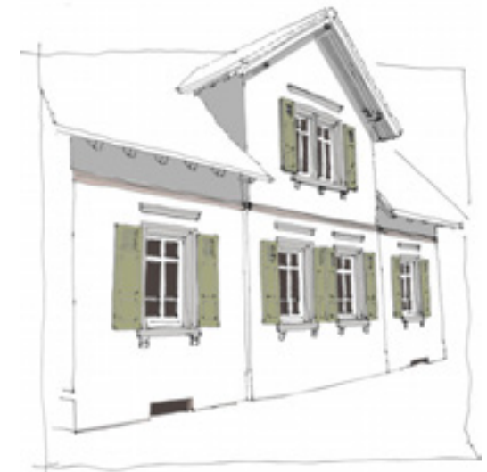
Gebäude ohne Sockel. Die tragende Basis des Gebäudes fehlt.
