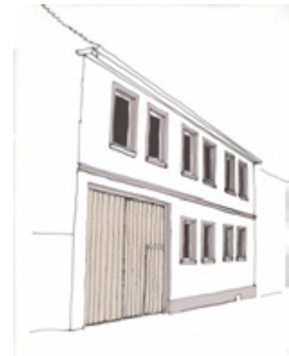
Zusammenhängende Fassade durch Angleichung der Fensteröffnungen und ein Hoftor.
